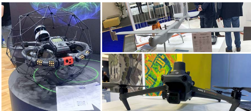
Kollektion verschiedener Systeme: Links: Drohne für Indoor-Kartierung; rechts oben: Drohne mit festen Flügeln, langer Flugzeit bis zu 90 Minuten und hoher Fluggeschwindigkeit bis zu 17 m/s; rechts unten: kleine und kompakte Drohne.
