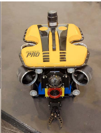
Messboot und Tauchroboter für bathymetrische Aufnahmen
