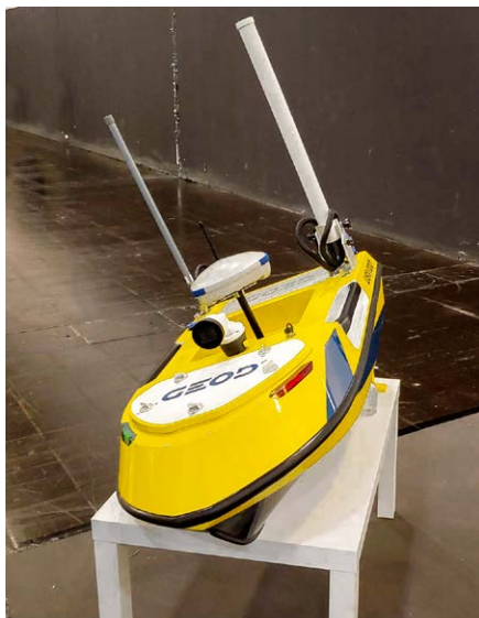
Messboot und Tauchroboter für bathymetrische Aufnahmen
