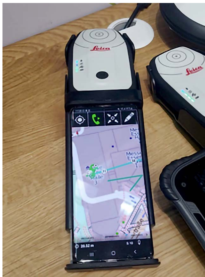
Mobile GIS-Hardware bestehend aus RTK-GNSS-Antenne, Smartphone und Halterung
