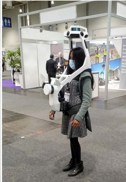
Mobile Mapping und Laserscanning: Mitglieder des Trendanalyse-Teams mit einem schultergetragenen mobilen Laser- scanner samt Kameras (oben) und ein mit Sensorik ausgestatteter autonomer Lauf- roboter
