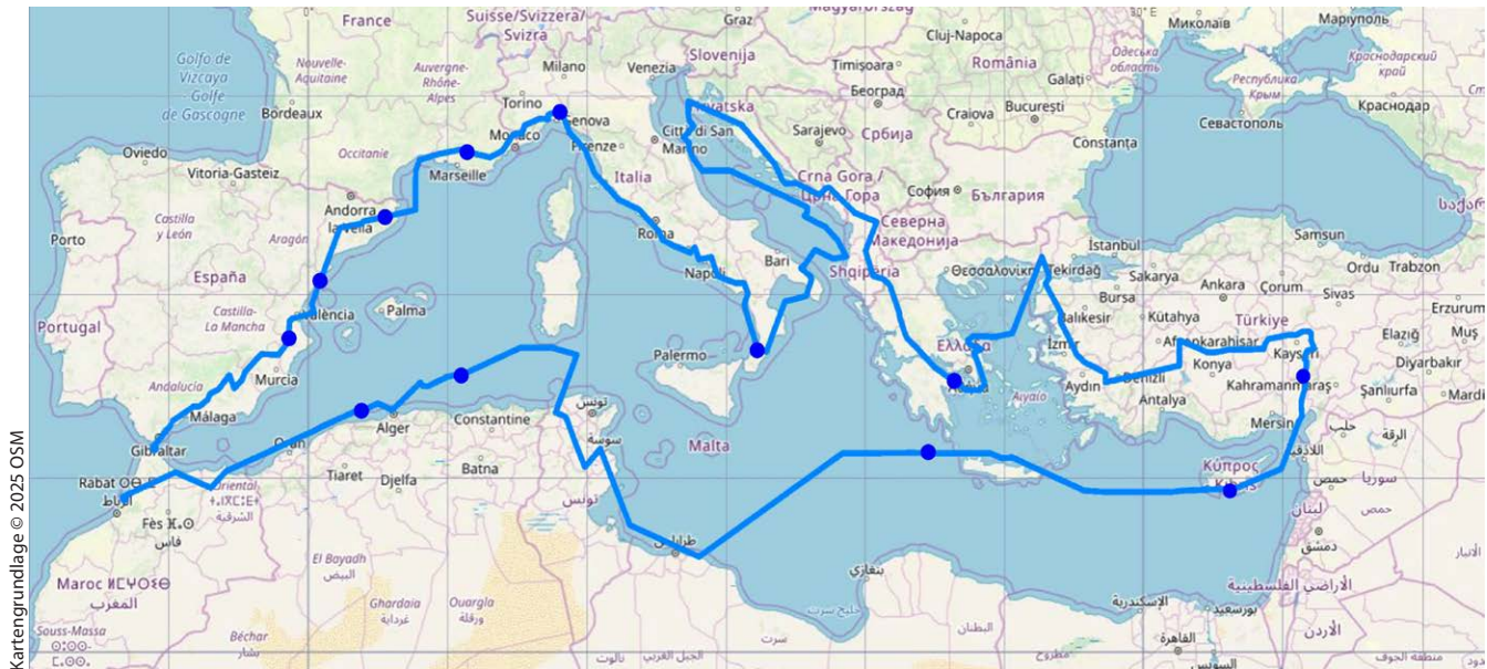
Abb. 8: Grafischer Vergleich der Auswertung des Vektorzuges der Küstenstruktur mit einer aktuellen Karte in Mercatorabbildung. Die aus Hochseestrecken konstruierten Festpunkte (Sektionspunkte) wurden durch blaue Punkte gekennzeichnet.
