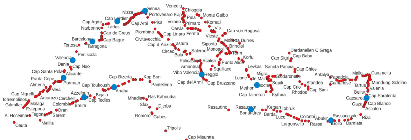
Abb. 7: Kartierung der 344 Standpunkte des Vektorzuges. Die aus Hochseestrecken konstruierten Küstenfestpunkte (Sektionspunkte) wurden durch blaue Signaturen gekennzeichnet.
