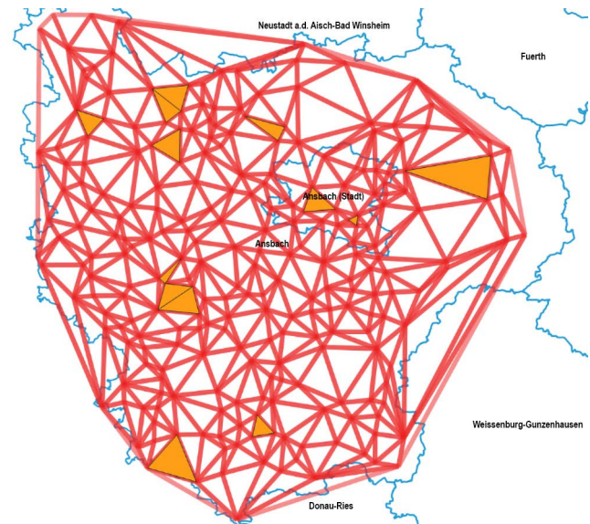
Abb. 15: Beispiel von gelöschten gleichseitigen oder gleichschenkligen Dreiecken im KI-Datensatz bezogen auf die aggregierten Siedlungsschwerpunkte 400 m (orange Flächen)
