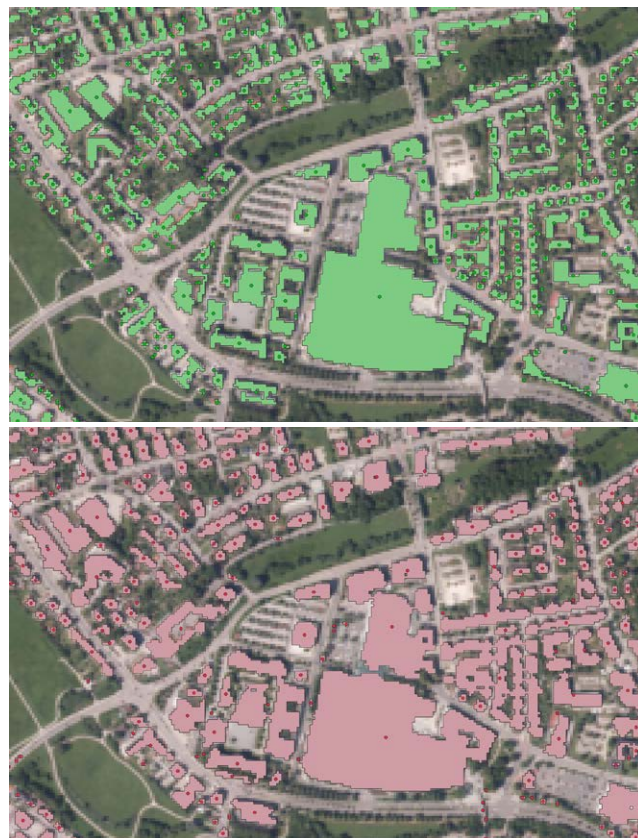
Abb. 6: Im Zielmaßstab als Sollwerte resampelte Gebäudegrundrisse der DFK mit ihren jeweiligen Gebäudeschwerpunkten in Grün (oben) und der KI-Ergebnisse in den resampelten TrueDOP-Kacheln in Rot (unten)
