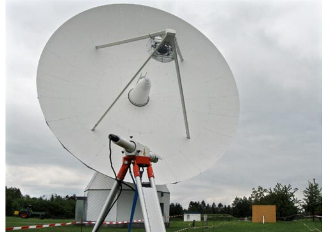
Abb. 6: Szintillometer und sein Laserbereich im Messgebiet seitlich des RTW
