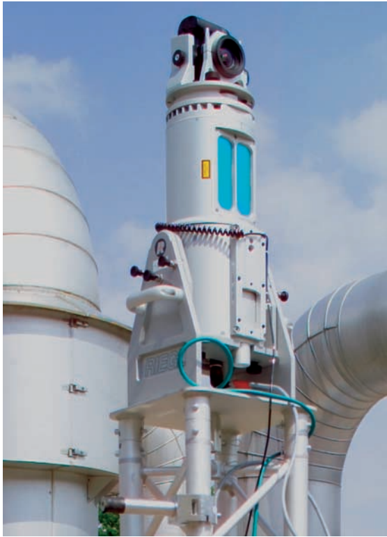
Abb. 1: Riegl-Scanner LMS-Z420i mit aufgesetzter Kamera Nikon D100
