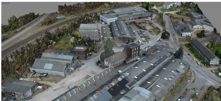
Abb. 1: Punktwolke des Objekts Dahlhauser Straße in Agisoft Photoscan
