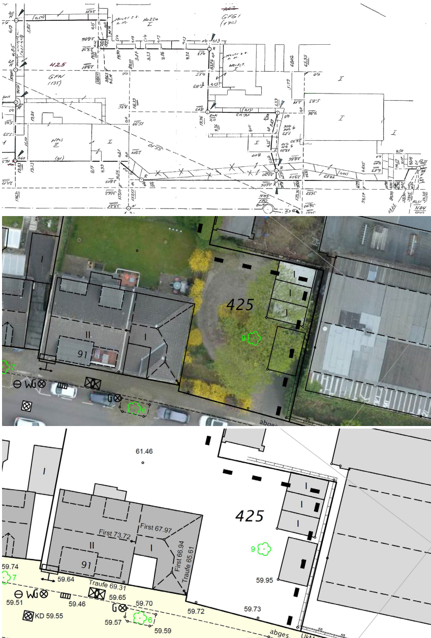
Abb. 5: Richtige Darstellung der Mauer im Vermessungsgriss (oben) und falsche Darstellung der Mauer im Lageplan (Mitte mit Luftbild und unten) aufgrund der ungenauen Katasterkoordinaten
