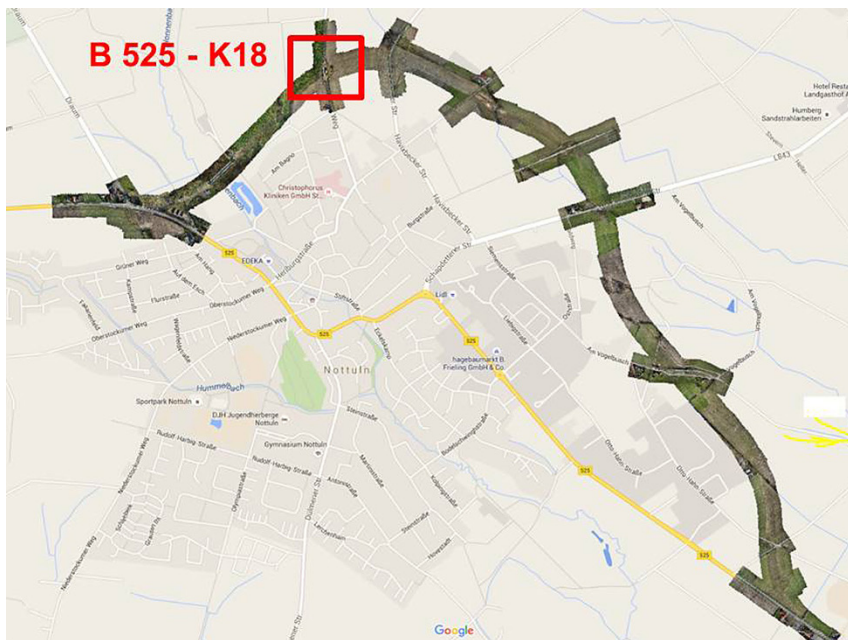
↑ Abb. 11: 3D-Punktwolke über 5 km mit ca. 1 Mrd. Punkten
