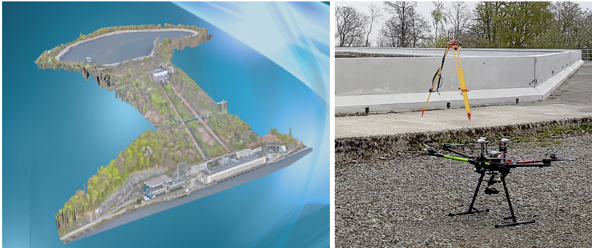
Abb. 3: Fototexturiertes 3D-Modell und Matrice 600 mit D-RTK
