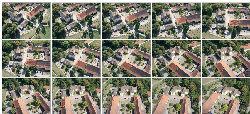
Abb. 1: Teilmenge der bei einer Drohnenebefliegung erzeugten Einzelfotos
