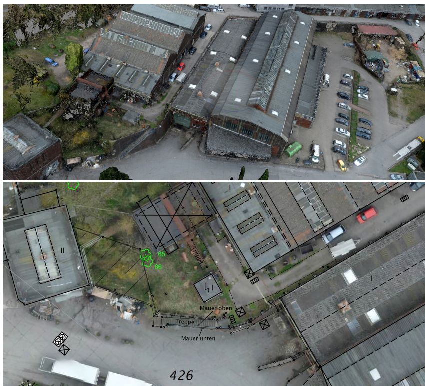
Abb. 4: In der Punktwolke sichtbare Topografieelemente (oben) und zum besseren Verständnis der Planinhalte hinterlegtes Orthofoto
