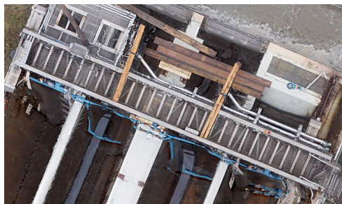
Abb. 14: Ungenügende Leitungsmodellierung im Orthofoto
