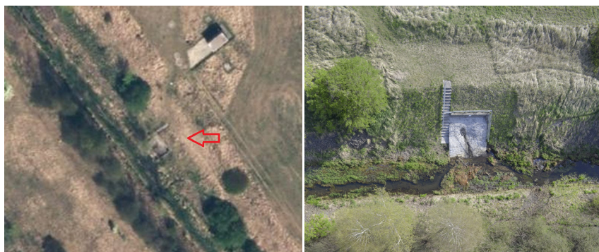
Abb. 3: Vergleich amtliches Foto mit 10 cm Auflösung (links) und Drohnenfoto mit 2 cm Auflösung (rechts)
