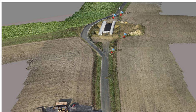
↑ Abb. 11: 3D-Punktwolke über 5 km mit ca. 1 Mrd. Punkten
