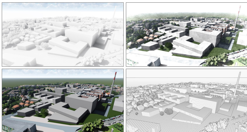
Abb. 9: Unterschiedliche Darstellungsmöglichkeiten eines 3D-Modells von Bestandsbebauung und geplanter Bebauung (Planung: fsp.Stadtplanung)
