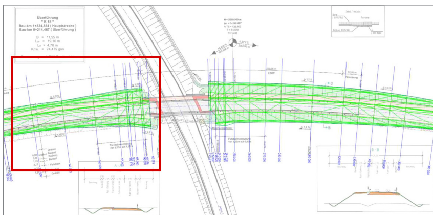
Abb. 19: Grundlage für die Daten der Baumaschinensteuerung
