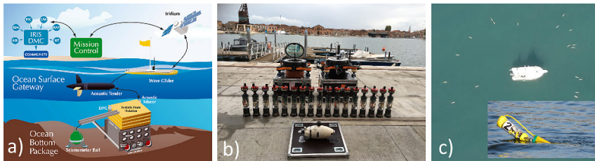
Abb. 7: a) Schematische Darstellung des Prototypens High Seas Telemetered Seismographic Observatory des Scripps Institution of Oceanography (Berger et al. 2016), b) Komponenten des subCULTron Umwelt-Monitoring-Systems (subCULTron 2018), c) SwarmDiver (Aqua-botix 2018)
