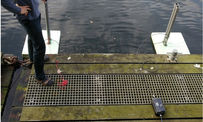
Abb. 12: Messaufbau der Untersuchung, bei dem Sender und Empfänger mittels Bojen im Wasser platziert sind.
