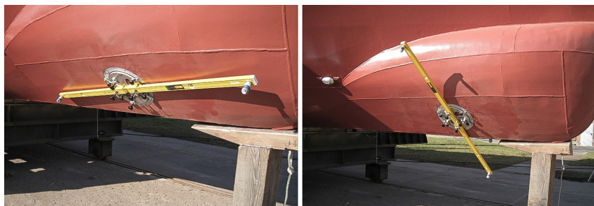
Abb. 16: Einmessung eines Transducers mit Verlängerungslatten
