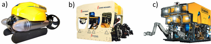
Abb. 4: Beispiele für ROVs verschiedener Größen: a) Mini-OCROV VideoRay ( videoray.com ), b) MSROV Super Mohawk II von Sub-Atlantic ( f-e-t.com ), c) WCROV Millennium Plus ( oceanengineering.com )
