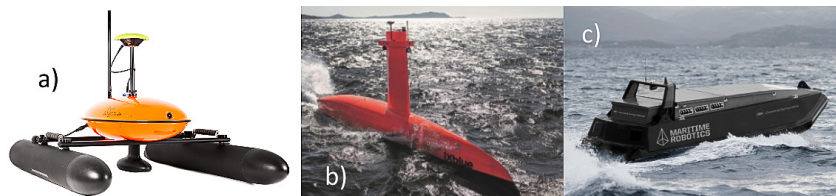
Abb. 6: Beispiele für USVs: a) SONOBOT ( evologics.de ), b) DriX ( ixblue.com ), c) Mariner ( maritimerobotics.com )
