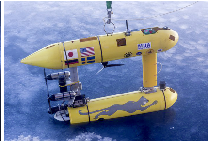
Abb. 4: Sehr lagestabiles, langsam fahrendes AUV JAGUAR (Woods Hole Oceanographic Institution; www.whoi.edu ; USA).
