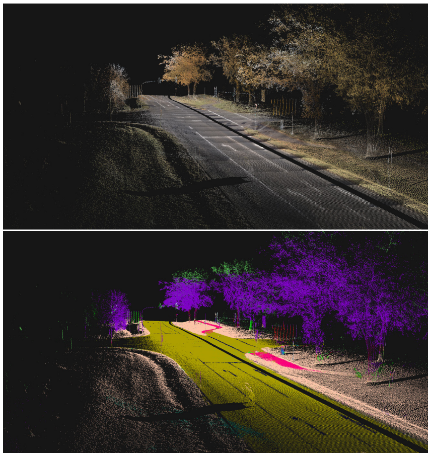
Abb. 8: Oben: texturierte Punktwolke; unten: interpretierter Datensatz mit Farbcodierung. Jede Farbe stellt eine eigene Objektklasse dar.
