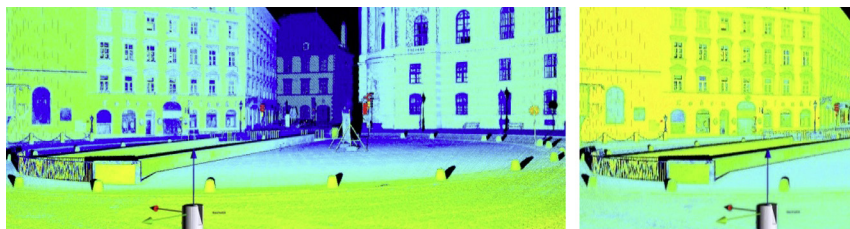
Abb. 1: Vergleich der Punktattribute Amplitude (links) und Reflektivität (rechts) anhand eines Datensatzes aus dem städtischen Bereich. Farbskala reicht von blau (gering) bis rot (hoch). Deutlich zu erkennen ist die Abnahme der Amplitude mit der Objektentfernung.
