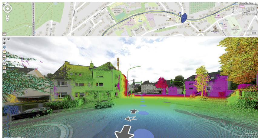
Abb. 9: Panoramakamera und Punktwolke im OrbitGT-Viewer (vgl. Website Orbit 2 2017)
