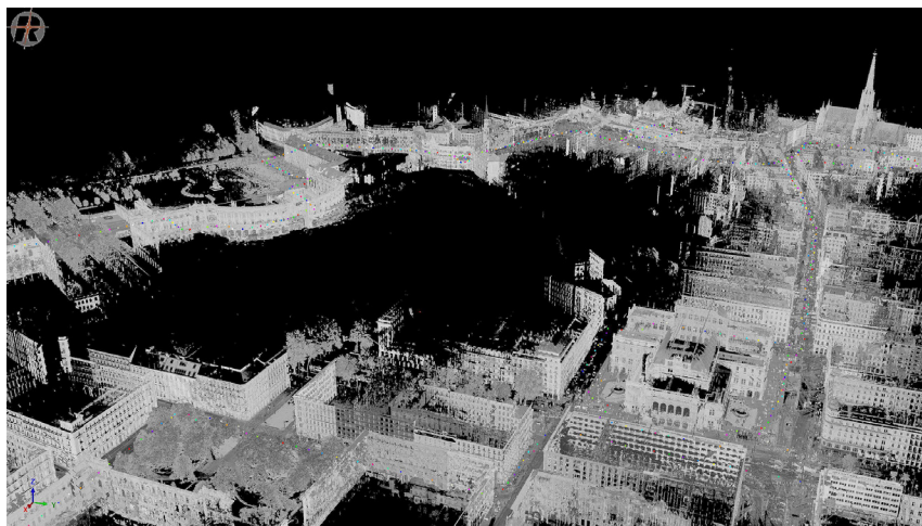
Abb. 5: Registrierte Scandaten der 514 Scanpositionen entlang des Aufnahmepfades
