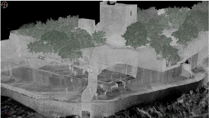
Abb. 7: Registrierte Punktwolke aus 180 Scanpositionen. In der Mitte des Bildes ist ein unterirdischer Gang zu erkennen.
